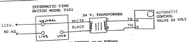
USING TIME SWITCH TO CONTROL MAIN BURNER
